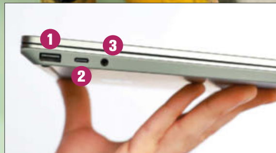
Kaum Anschlüsse: Eine USB-Typ-A- 1 und eine USB-C-Buchse 2 plus ein Headset-Anschluss 3 müssen reichen. Das ist auch für diese Geräteklasse mau.
