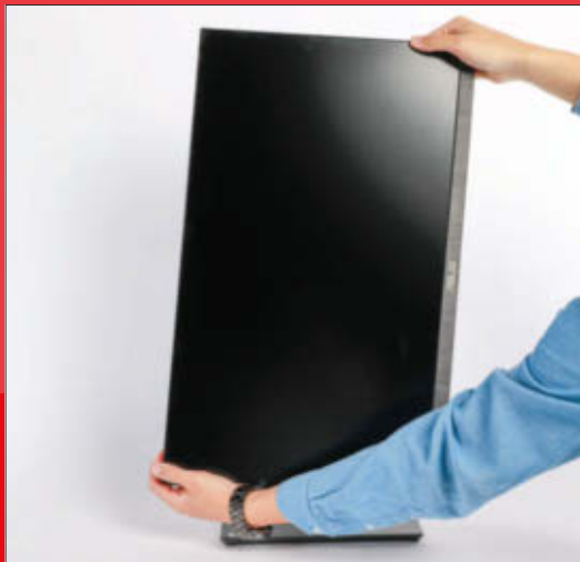
Ein Drehen des Monitors ins Hochformat (Pivot-Funktion) wie beim Asus ist nützlich, um lange Texte zu schreiben.
