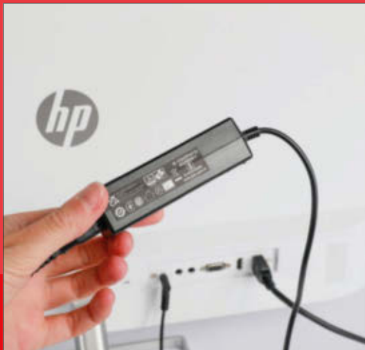
Drei Monitore (AOC, HP, Xiaomi) kommen mit einem externen Netzteil. Beim HP fällt es am kleinsten aus.
