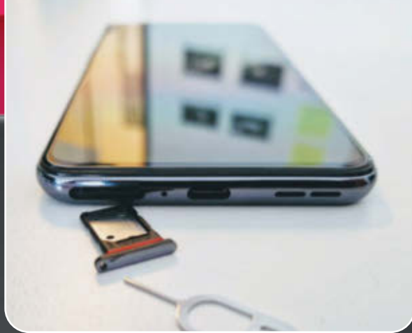
Unterseite: USB Typ C und Dual-SIM ja, Schacht für Speicherkarten oder Klinkenbuchse für alte Kopfhörer nein.
