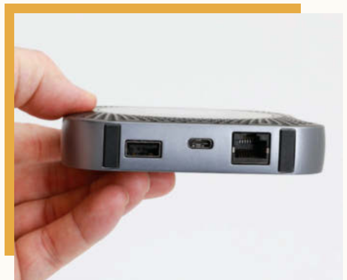
Die Netgear-Router und der Telekom haben eine Netzwerk-LAN-Buchse. An den Nighthawk M1 (oben) lassen sich USB-Festplatten anschließen.
