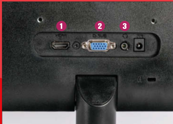
Bei günstigen 27-Zöllern wird bei der Ausstattung gespart. Der AOC 27B2H muss mit drei Anschlüssen auskommen: HDMI 1, VGA 2 und Kopfhörer 3.
