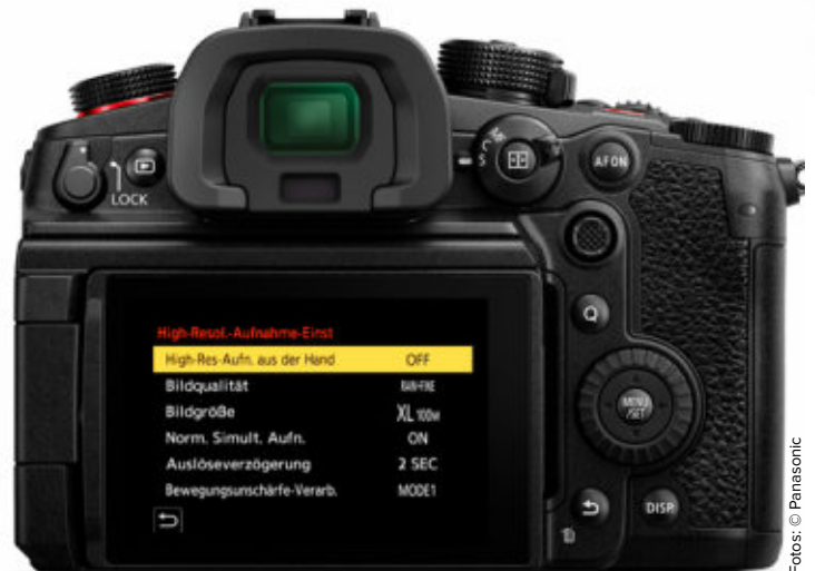
Die Knöpfe und Räder der GH6 sind angenehm groß und lassen sich auch mit Handschuhen bedienen.
