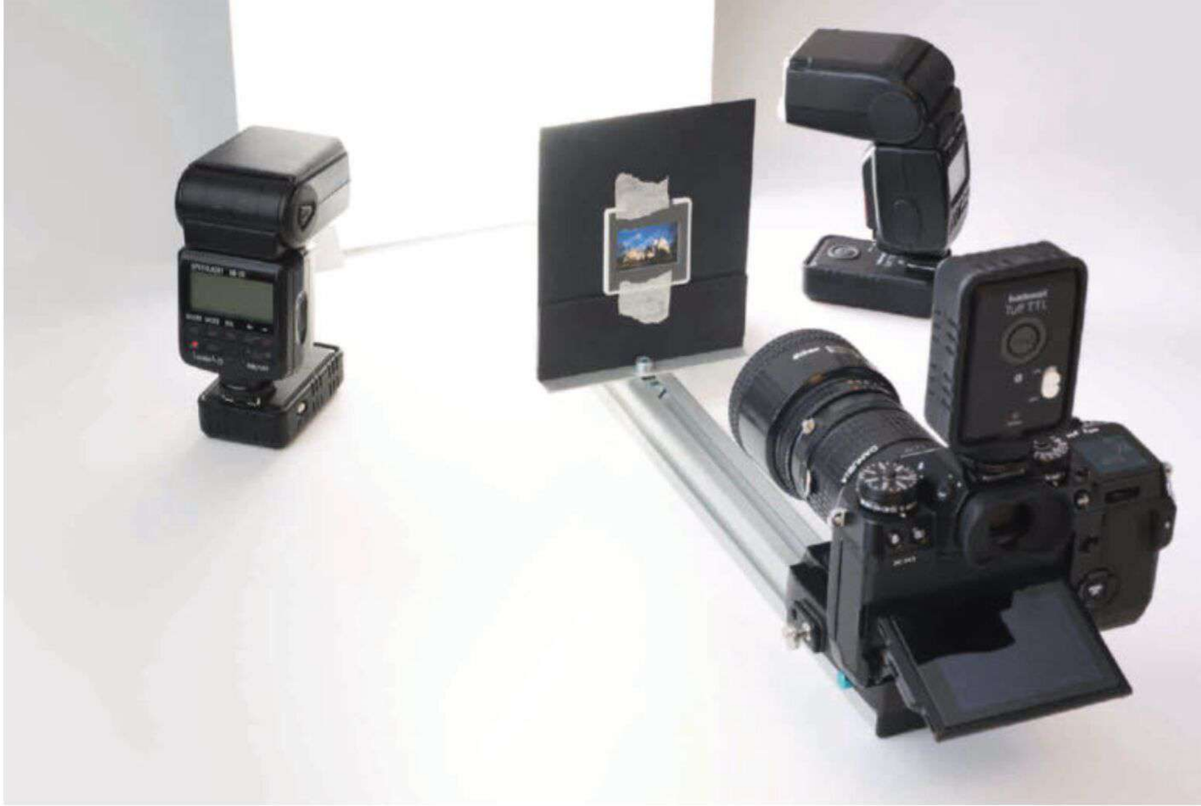
Eine angeblitzte weiße Fläche eignet sich gut für eine homogene Ausleuchtung. Als Lichtquelle zum Scharfstellen reicht eine Taschenlampe.
