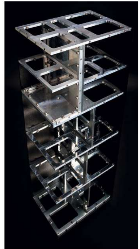
Links: Die äußeren Gehäusewände eines Lautsprechers von Bowers & Wilkins sitzen auf Spanten, die die Resonanzfrequenzen über den Arbeitsbereich der Bässe treiben.
