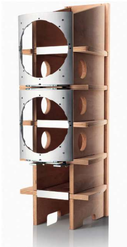
Links: Die äußeren Gehäusewände eines Lautsprechers von Bowers & Wilkins sitzen auf Spanten, die die Resonanzfrequenzen über den Arbeitsbereich der Bässe treiben.
