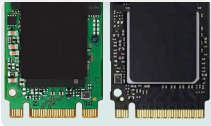
SATA-M.2-SSDs sind an zwei Kerben zu erkennen (im Bild links). SSDs mit PCI-Express-3.0- oder -4.0-Anschluss haben nur eine Kerbe (im Bild rechts).
