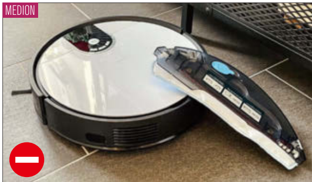
In den wackelig sitzenden Tank des Medion passte nur ein Schluck Wasser (etwa 100 Milliliter). Schlimmer: Im Test gelangte davon kaum etwas aufs Wischtuch oder auf den Boden. Feucht durchwischen geht anders!
