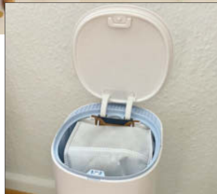
...gibt's eine Absaugstation, die den eingesammelten Schmutz im großen Staubbeutel aufbewahrt und so lange ohne menschliche Hilfe auskommt.
