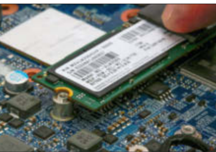
Einfache Installation: M.2-SSD schräg in den Steckplatz schieben, runterdrücken, mit einer Schraube befestigen.
