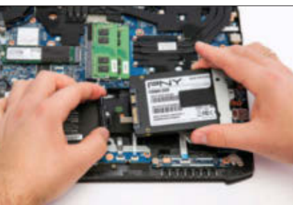
In älteren Notebooks und PCs lässt sich die Festplatte recht einfach gegen eine schnellere 2,5-Zoll-SSD tauschen.
