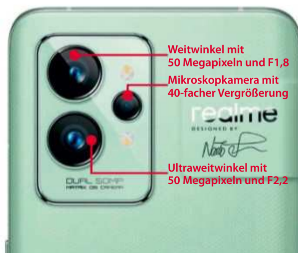
Realme setzt wie Motorola auf zwei hochauflösende 50-Megapixel-Sensoren, baut aber zusätzlich noch eine Mikroskopkamera ein.
