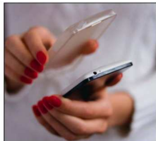
Bei Hitze: das Cover abnehmen. Plastik isoliert, und das Gehäuse verliert seine Kühlwirkung.
