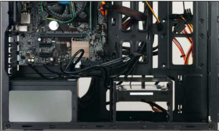
In modernen Rechnern ist das Netzteil unten eingebaut. Der Lüfter saugt kühle Luft von unten in das Netzteil hinein und nach vorn wieder hinaus.
