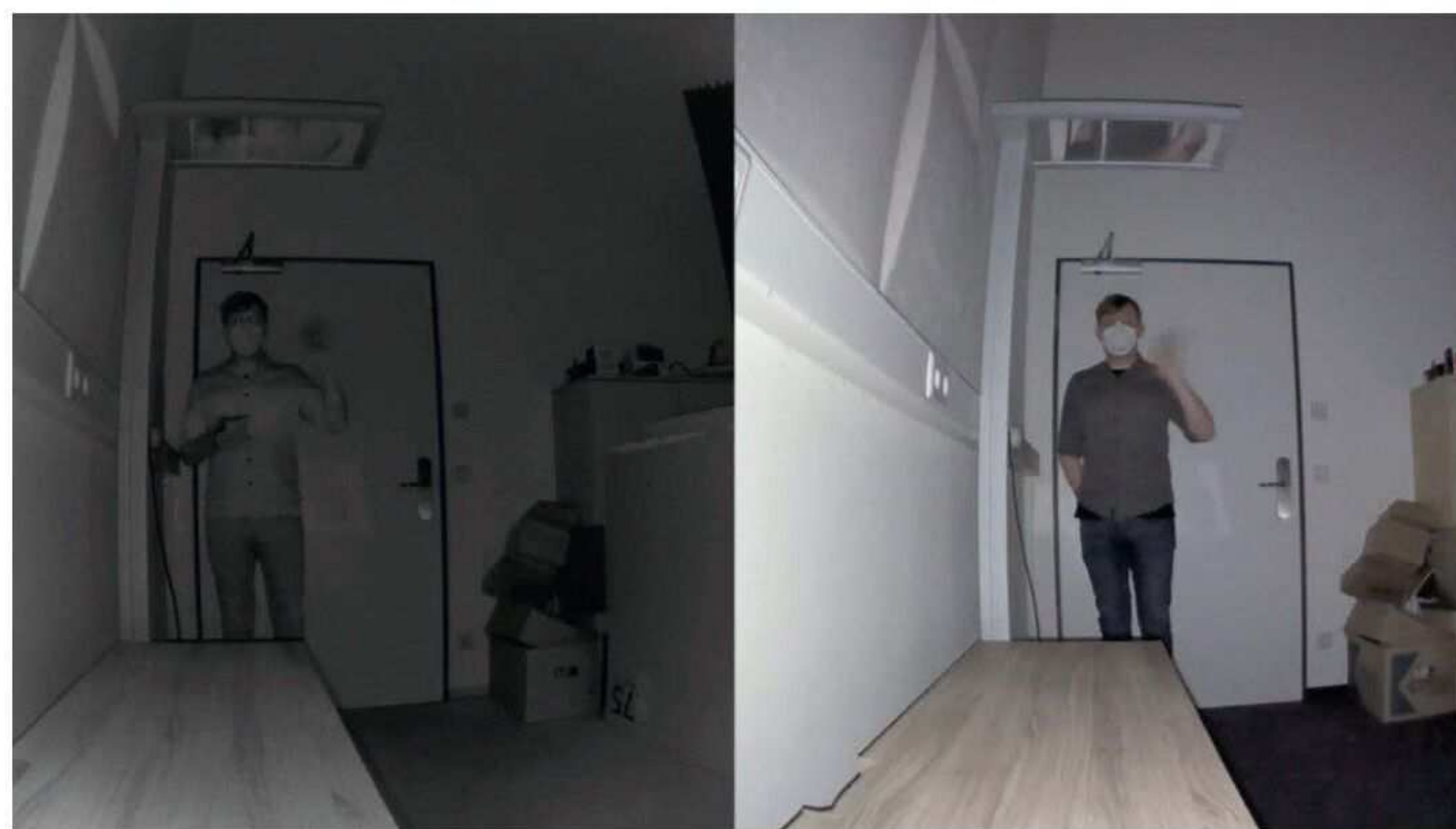
Die Nachtaufnahmen der Arlo Pro 4 können sich sehen lassen. Im Infrarotmodus (links) wie auch mit zugeschaltetem Flutlicht (rechts) sind viele Details erkennbar.
